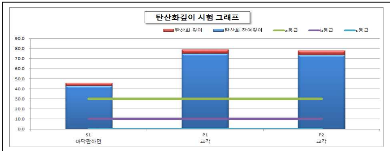
【그림 17.4.7】상주방향 탄산화 깊이 측정결과
